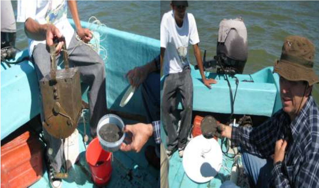
Izquierda, toma de muestras de sedimentos del lago con la draga Ekman; a la derecha, se observa el disco secchi, la botella Van Dorn, así como la muestra de sedimentos
