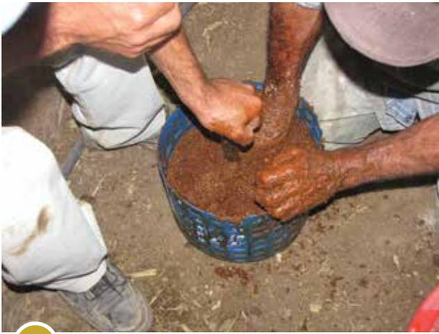
Compactado de la mezcla en los moldes.
