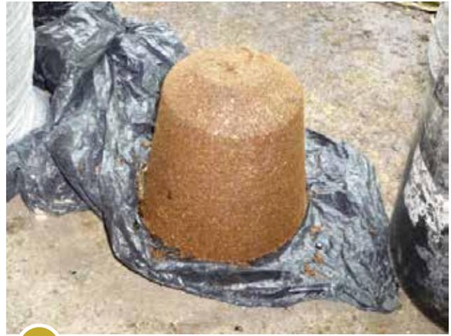
Bloque fuera del molde, listo para colocar a secar en el sol.
